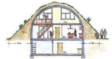
Schnitt durch das Erdhügelhaus (Schema Archy Nova).
